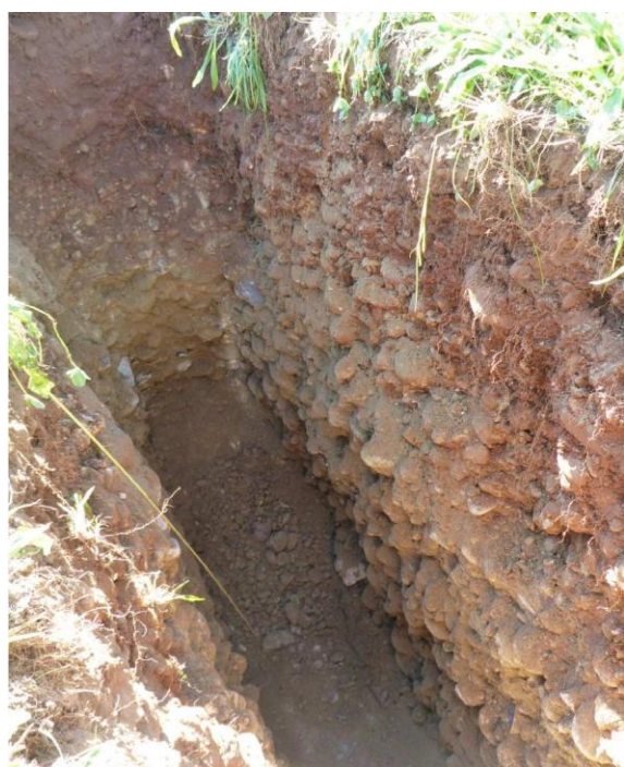
Figure 6. Photos du sous-sol prises par GINGER CEBTP lors des mesures d'infiltration
