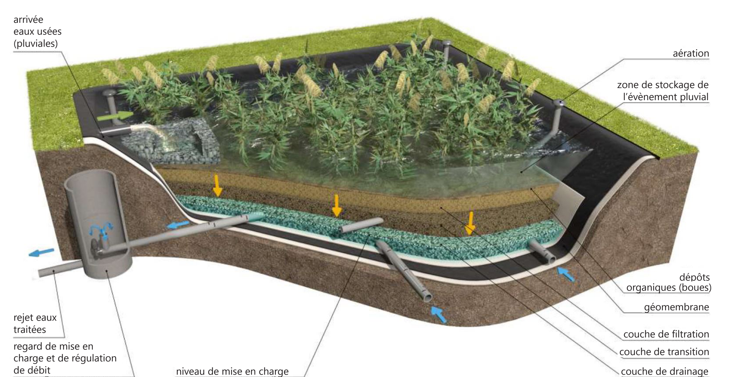
Principe de fonctionnement du bassin multifonction (avec système anti-moustique)
