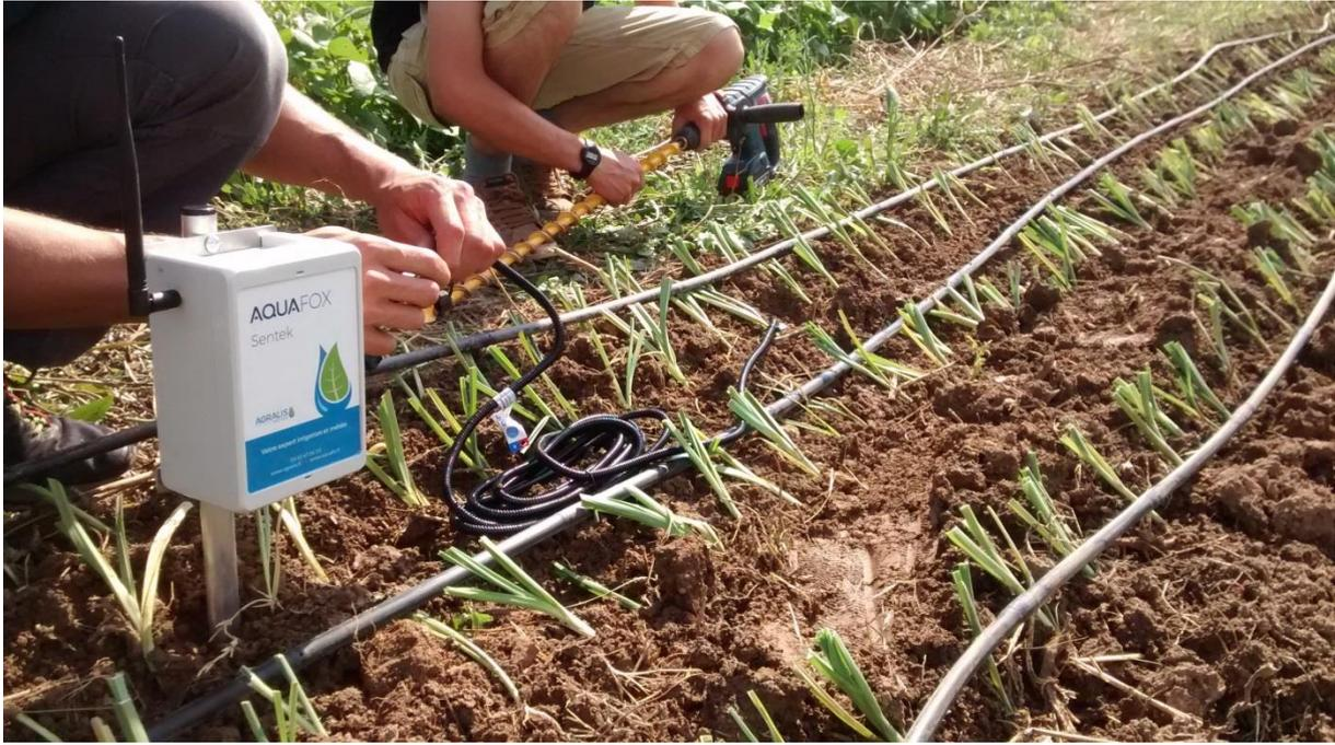
**Installation d'une sonde capacitive sur une production de poireau – Aubagne 2018.**
