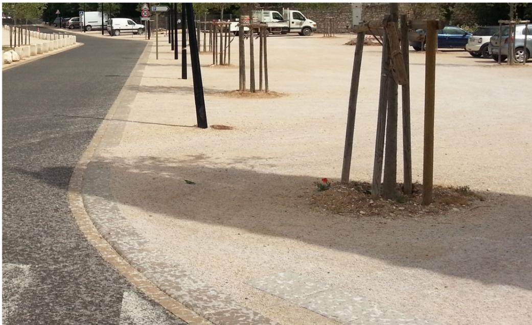
**Bordure large + 1 rang de pavés > stationnement en stabilisé**
