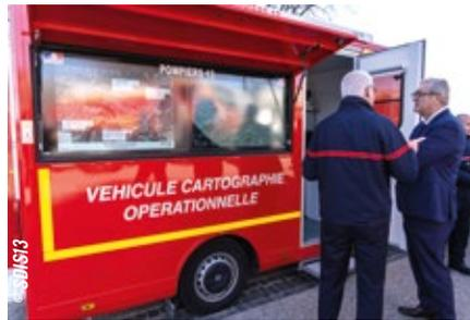
Positionné directement sur le théâtre des opérations, ce véhicule doté d'écrans 3D diffuse les images capturées par Horus 13 et les drones du SDIS 13. Il permet de fournir une cartographie du feu, en temps réel, avec une précision redoutable. Avec sa grande capacité de tirage de cartes au format papier, il aide les autorités de supervision et le commandement à prendre des décisions importantes et à orienter les équipes sur le terrain.
